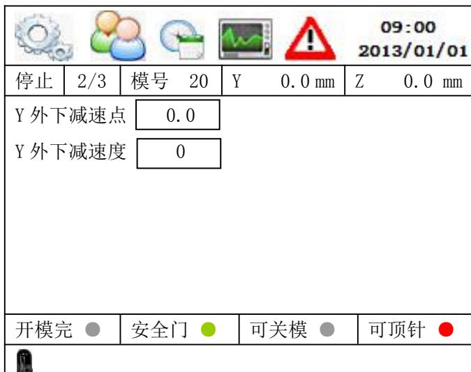
24、Y 外下减速点：Y 轴在型外下降的提前减速位置。
