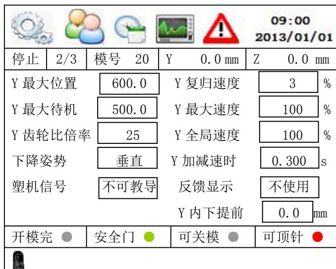
\*13、Y 最大位置：设定 Y 轴的最大位置，需配合机器实际位置使用，Y 轴各项位置设定值必须小于此设定值。
