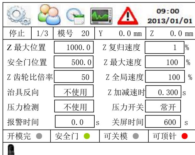
\*1、Z 最大位置：设定 Z 轴的最大位置，需配合机器实际位置使用，Z 轴各项位置设定值必须小于此设定值。
