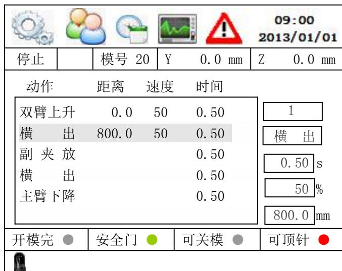
按光标上、下键将光标移动到要修改参数的动作，修改好参数后按
